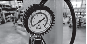
Inflador de neumáticos con manómetro Tyre inflator with pressure gauge
