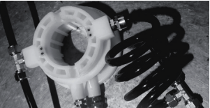
Válvula rotativa completa de plástico Plastic complete rotary valve
